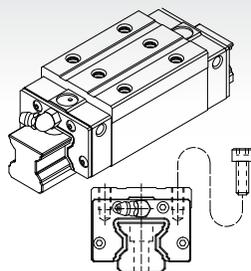
与SMR-S型具有相同断面尺寸，增加滑块的长度，并增加负荷滚柱数，提升整体的负荷能力。
