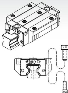
与SMR-E型具有相同断面尺寸，增加滑块的长度，并增加负荷滚柱数，提升整体的负荷能力。
